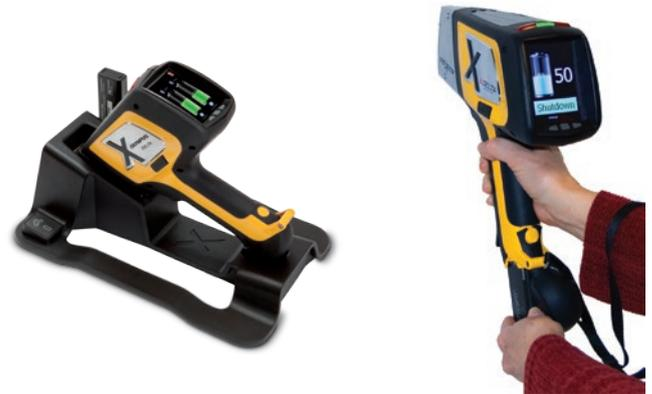
ドッキングステーション\*は、本体と予備のバッテリーに充電を行い、定期的に CalCheck(校正チェック)を行います。全ての DELTA シリーズには、電源を入れたままバッテリー交換ができるホットスワップ機能を搭載しています。
