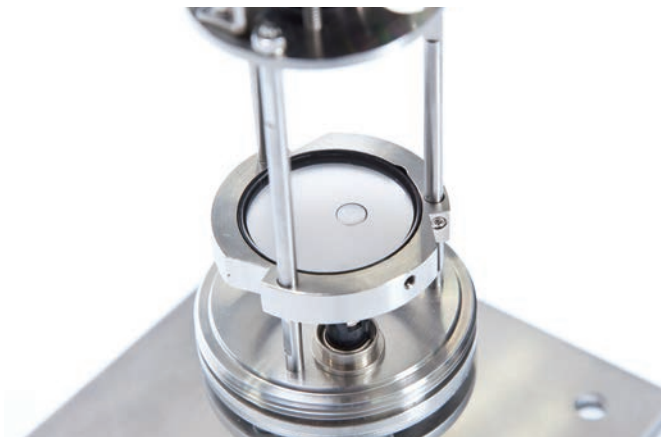
水準器の気泡の位置で傾きを検知し、上部カメラで撮影・解析します。
